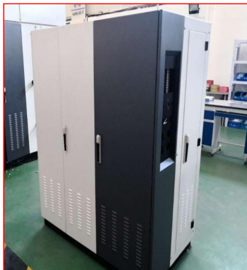
图2 产氢 5 Nm 3 /h(3MPa)制氢机
